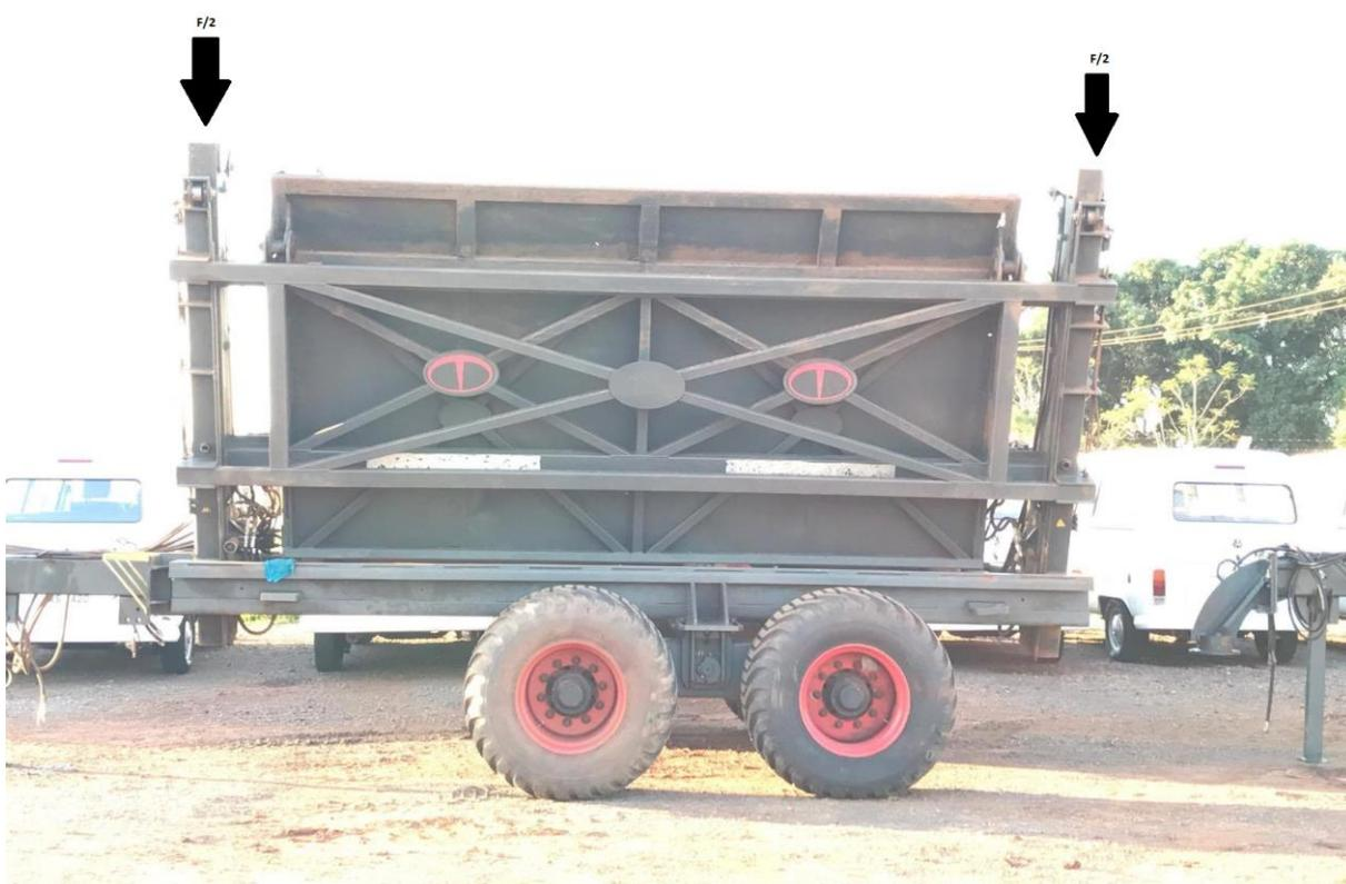
**Figura 6 - Foto real do transbordo MCT 10500 e posicionamento das forças distribuídas.
