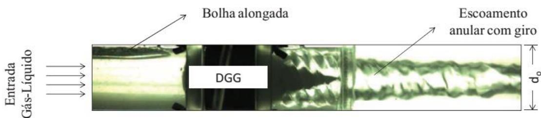
Figura 1.3 - Escoamento bifásico (gás-líquido) em um ciclone axial (Rocha. 2014)
