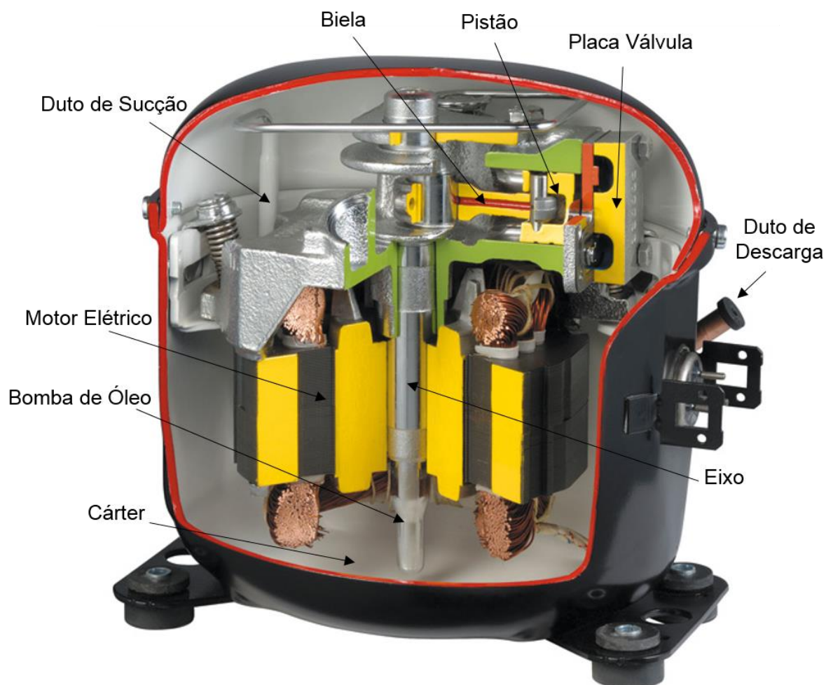
Figura 3 – Corte de um compressor hermético a pistão Fonte: Adaptado de catálogo eletrônico Tecumseh
