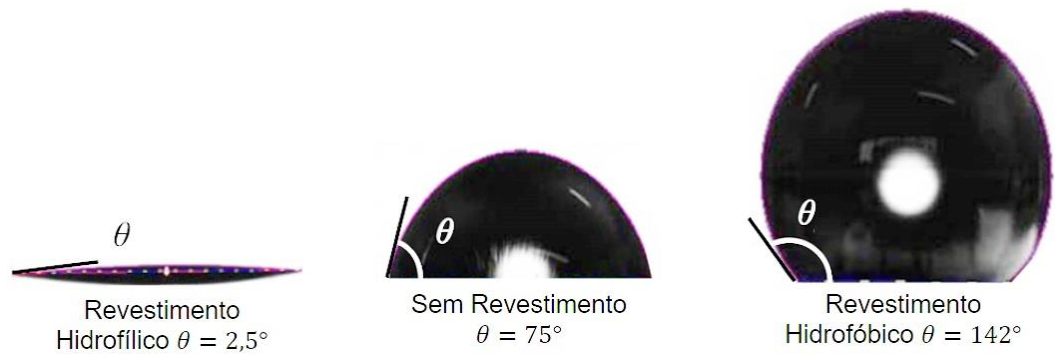
Figura 7 – Ângulo de contato para diferentes revestimentos.
