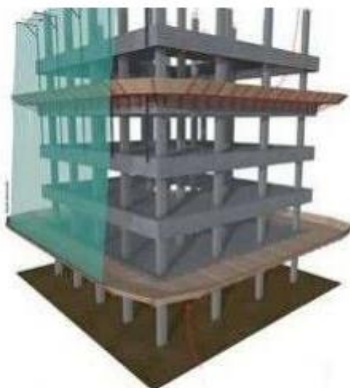
Figura 5 – Plataformas de proteção
