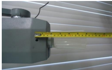
Figura 27 - Arranjo experimental para determinar a distância foco-pele
