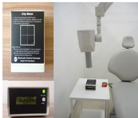
Figura 25 – Experimento para verificação da tensão
