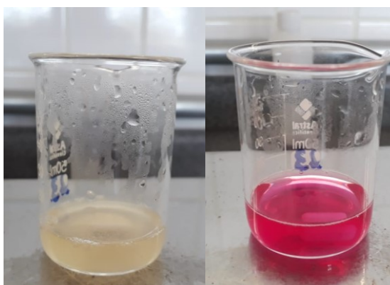
Figura 14- Pectina solubilizada em água destilada mais o indicador fenolftaleína antes e após à titulação com NaOH.
