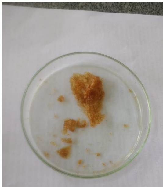
Figura 13 - Pectina após secagem em estufa.
