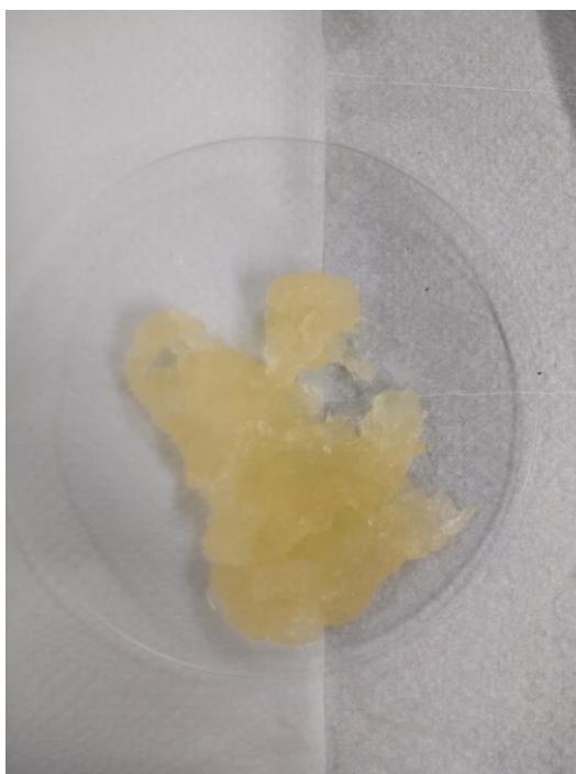
Figura 12 - Pectina extraída após etapa de filtração a vácuo.
