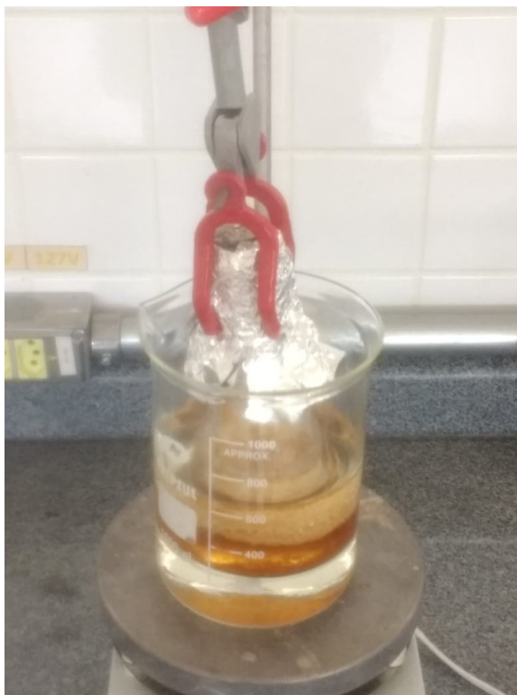
Figura 11 - Estrutura montada para etapa de extração ácida da pectina da farinha do maracujá.
