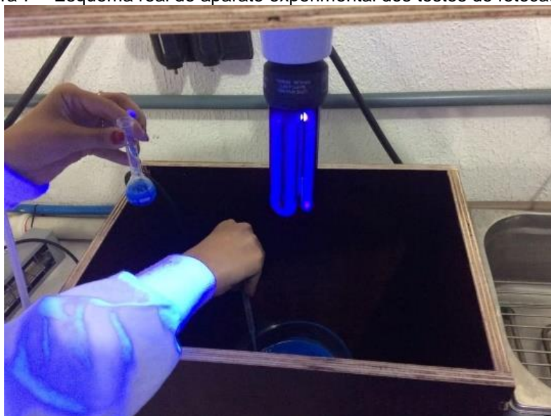
Figura 7 – Esquema real do aparato experimental dos testes de fotocatalise.
