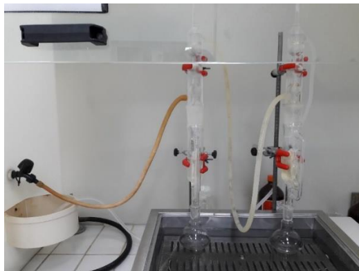
Figura 9 - Aparato Soxhlet empregado para a extração do óleo de soja Fonte: autor.
