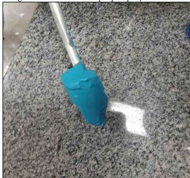
Figura 12 - Lodo formado após precipitação de metais
