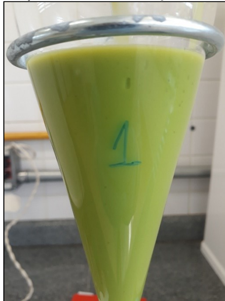
Figura 8 – Formulação de 3,5% v/v de 8-HQ e 5,12% v/v de SPAN 80®
