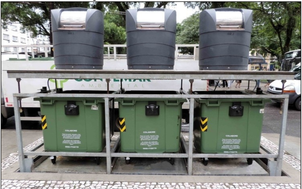
Figura 22 - Contêiner subterrâneo - 660L
