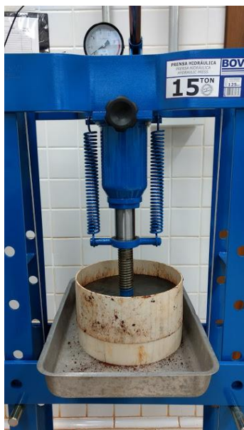
Figura 14: Vaso de PVC compactado com 2 toneladas
