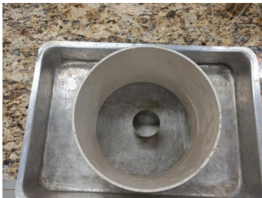
Figura 10: Anel metálico inserido dentro do Anel de PVC sobre a forma de alumínio.
