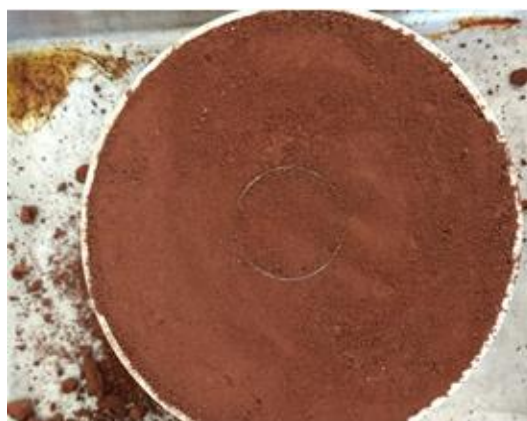
Figura 15: Vista fundo anel de PVC após compactação.
