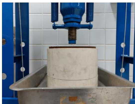
Figura 13: Amostra de solo sendo compactada.
