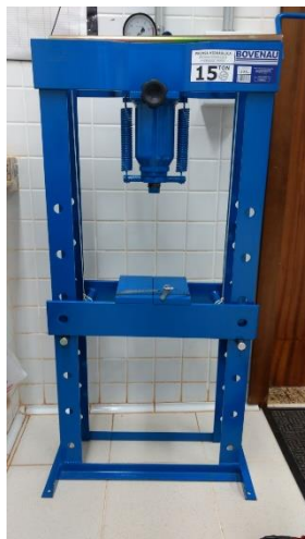
Figura 8: Prensa Hidráulica Manual utilizada no experimento.
