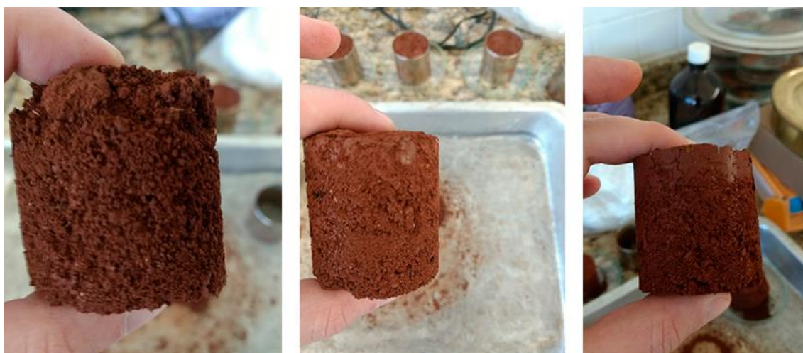
Figura 19: Amostras de solo compactadas com 1, 2 e 3 toneladas respectivamente em umidade de 30%.
