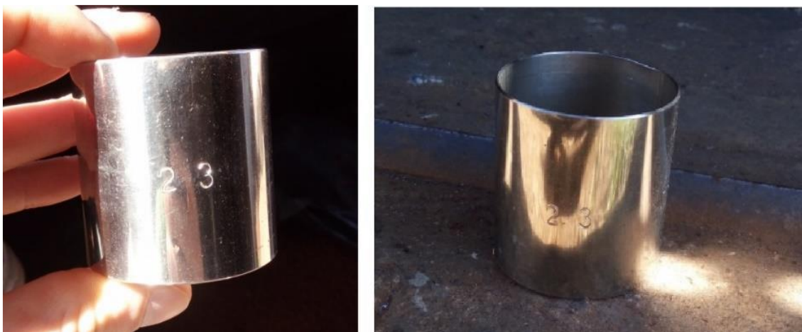
Figura 9: Cilindro metálico utilizado na determinação das densidades.
