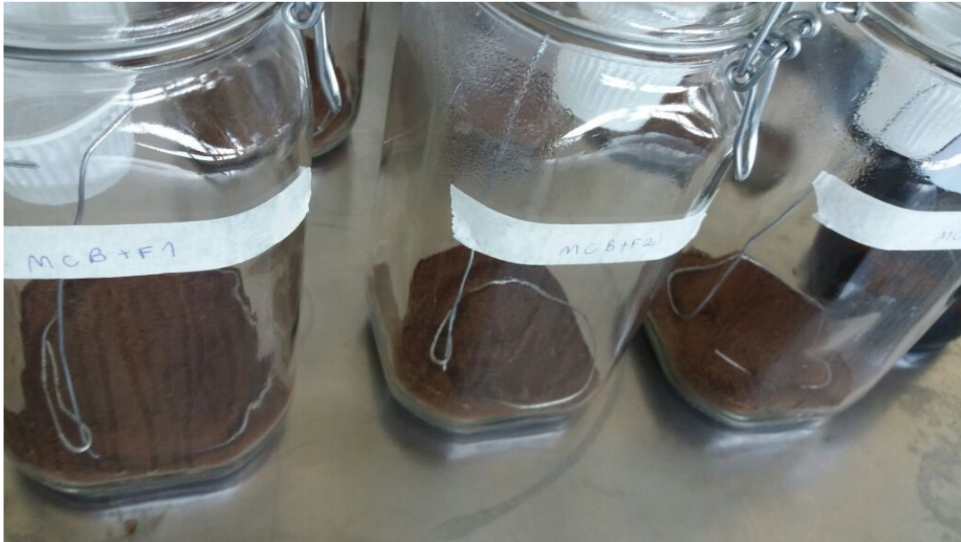
Figura 14. Microcosmos utilizados nos ensaios de respirometria, onde pode ser visto os recipientes plásticos contendo NaOH para captura química do CO 2 liberado.
