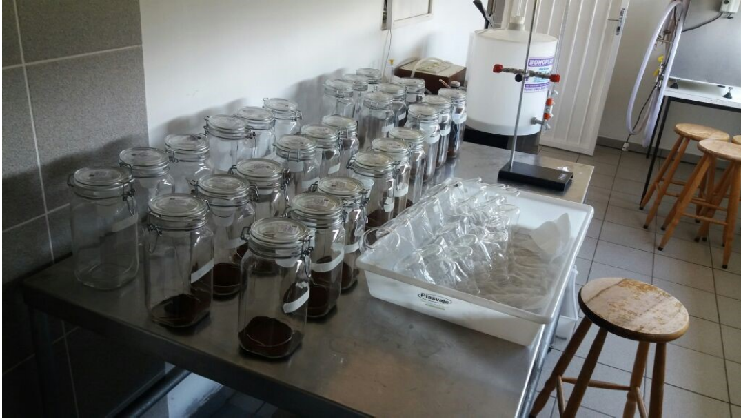
Figura 13. Ensaio em microcosmos para a análise da evolução de C-CO 2 (respirometria).
