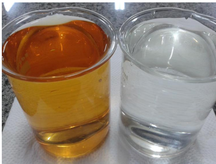
Figura 33 – Efluente água vermelha bruto e pós tratamento no reator fotocatalítico.
