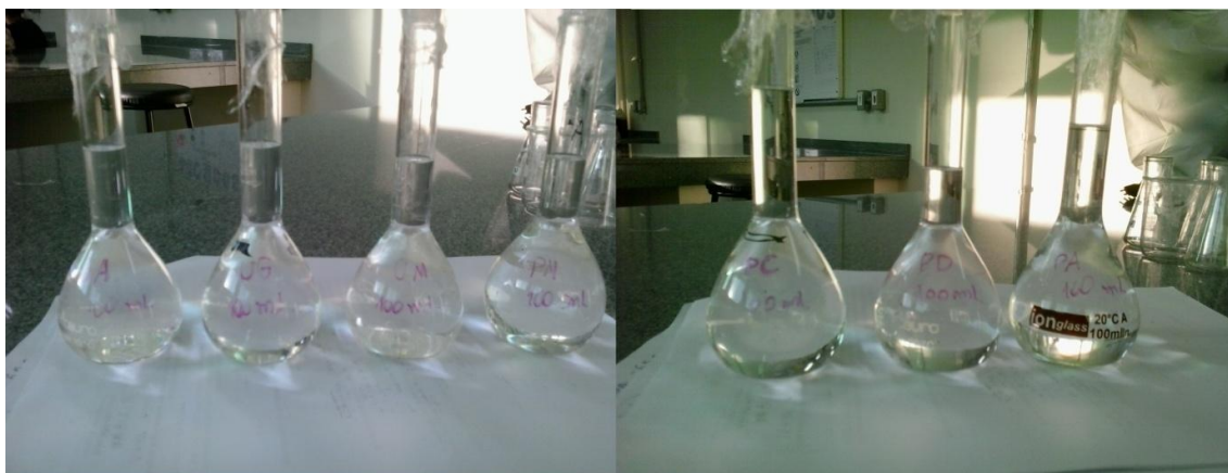
Figura 6– Amostras para leitura de absorvância. A cor azul indica a presença de surfactantes na amostra pela adição do reagente azul de metileno Fonte: Arquivo pessoal (2016).
