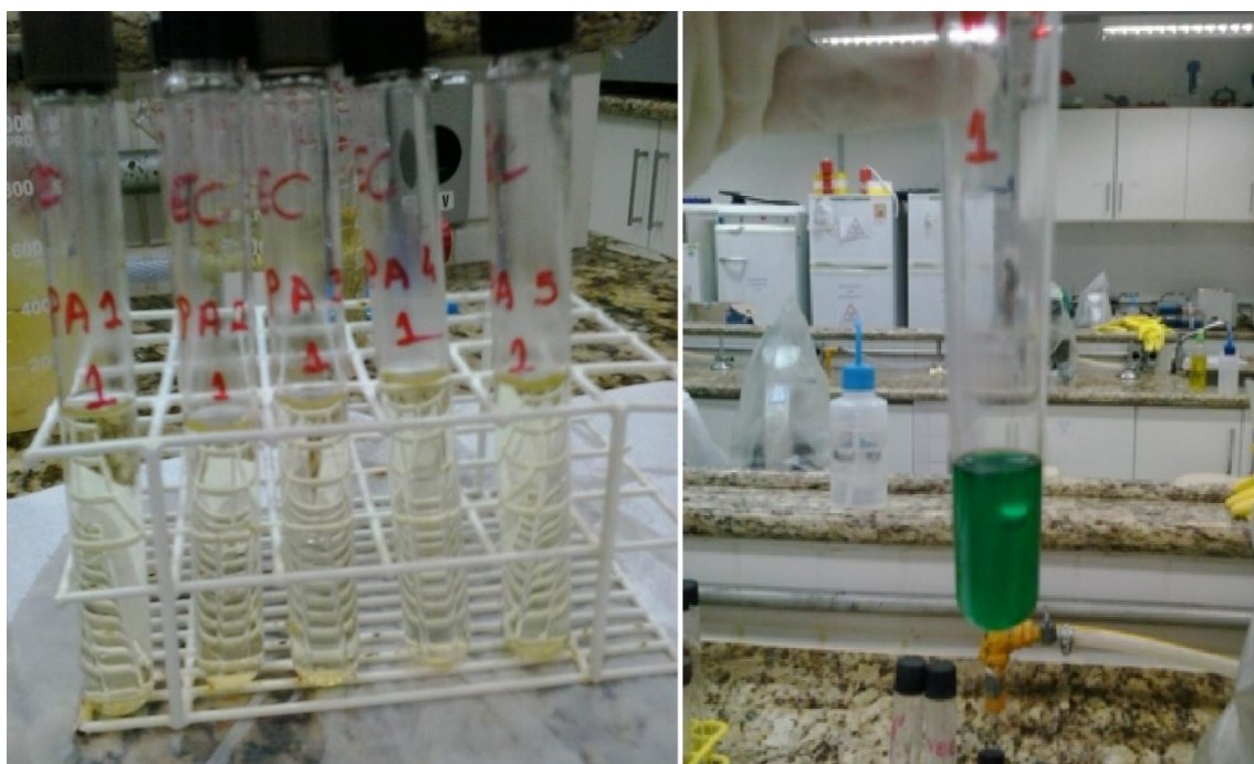
Figura 7 - À esquerda, tubos de ensaio sem a formação de gás no tubo de Durham, indica teste negativo. À direita, tubo de ensaio apresentando turbidez no meio e formação de gás no tubo de durhan, indica teste positivo
