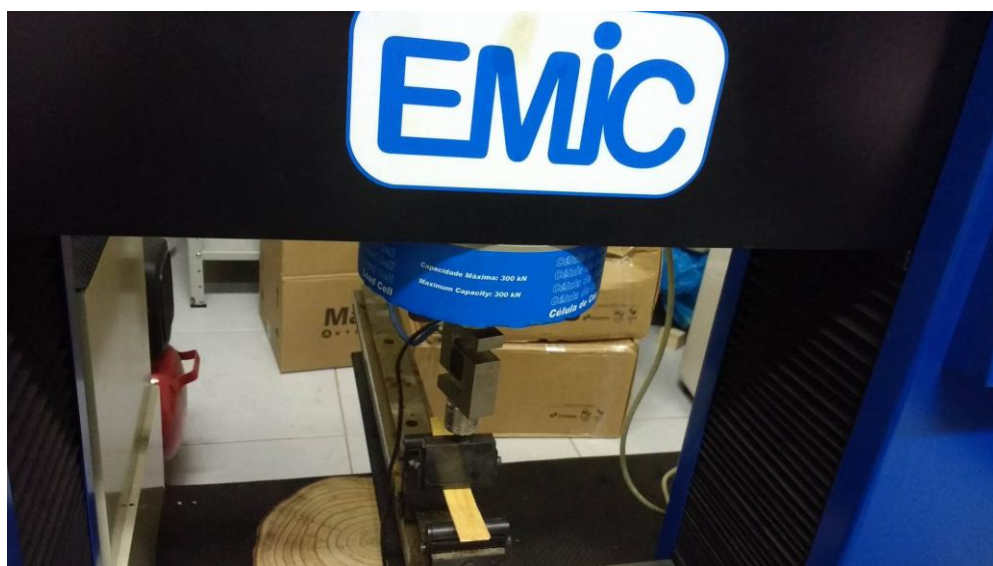
Figura 2: Ensaio mecânico das laminas de Pinus sp.
