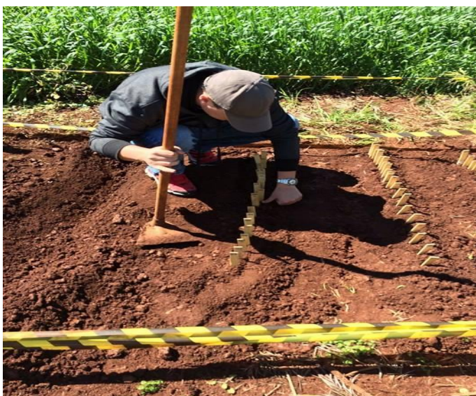
Figura 1: Introdução das lâminas em campo de apodrecimento. Fonte: O autor (2017).
