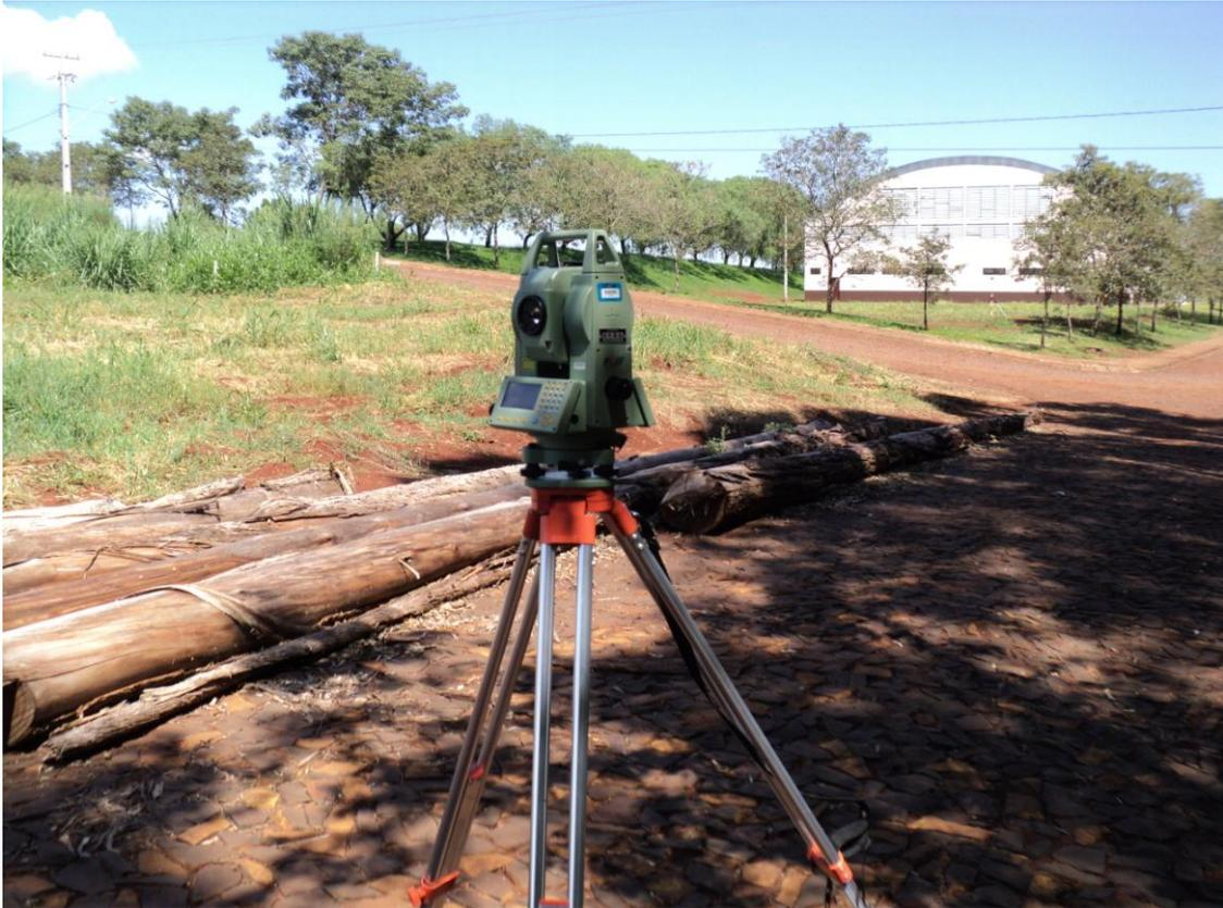
**Figura 4 - Estação Total FOIF® modelo OTS685(L)**
