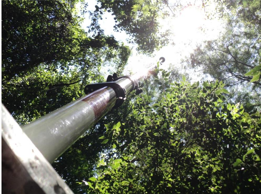
**Figura 21 – Rastreio de pontos com antena elevada através de bastão extensível em Floresta Estacional Semidecidual em Estágio Intermediário de Regeneração**
