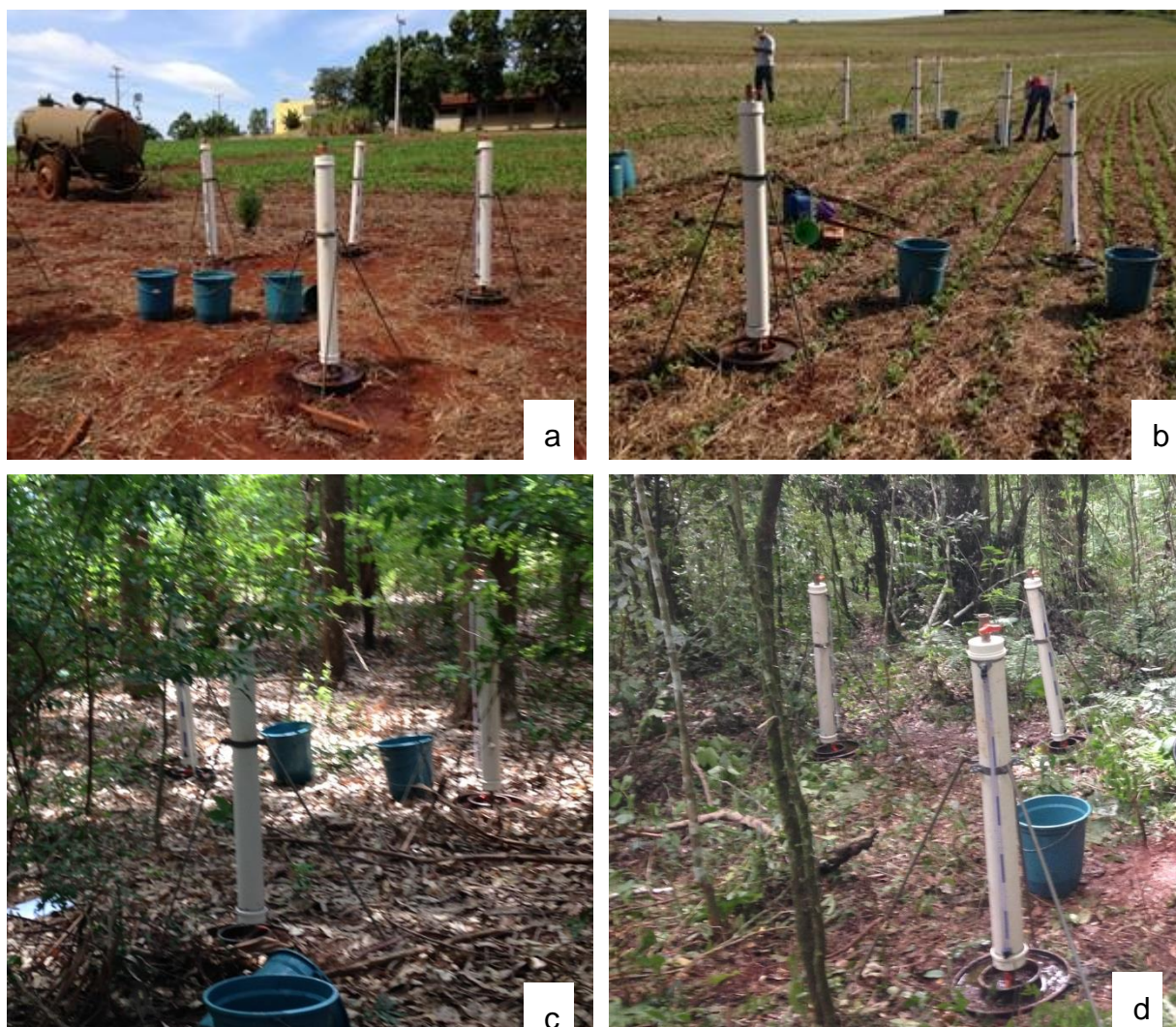
Figura 3: Avaliação de infiltração de água no solo nos usos: (a) PC, (b) PD, (c) EU e (d) FN. Fonte: O autor, 2014.
