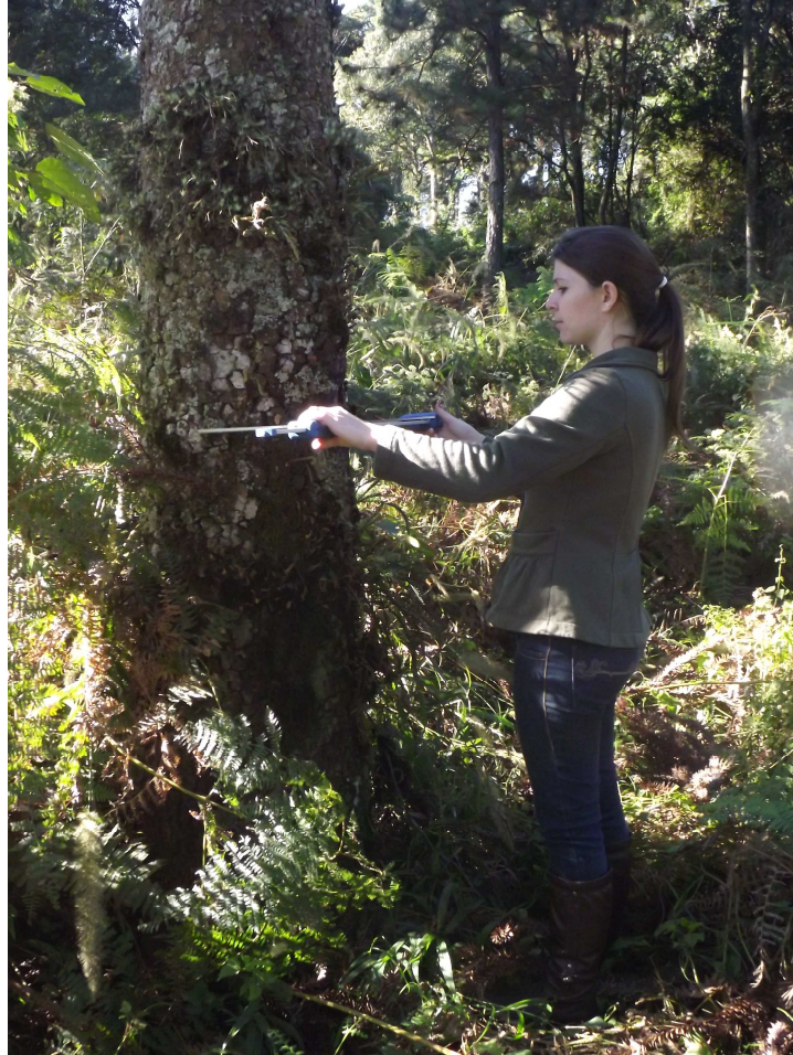
Figura 4 – Medida do dap com o uso da suta dendrométrica. Fonte: O autor (2013).
