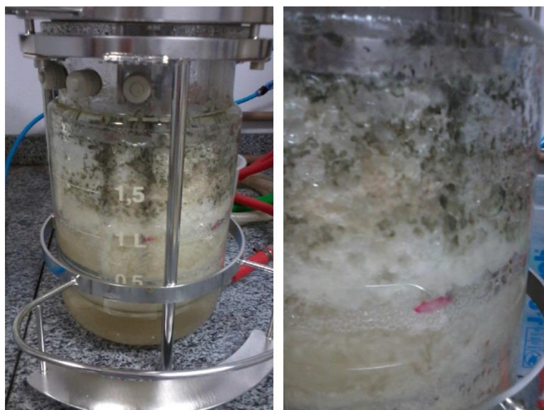
Figura 11 – Crescimento fúngico em biorreator de bancada ao final de 72 h de cultivo.
