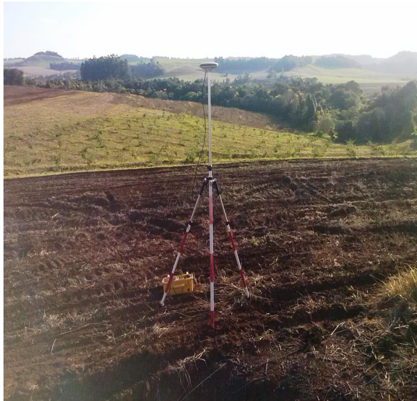
Figura 3. Levantamento a campo com GPS Geodésico em área de lavoura.
