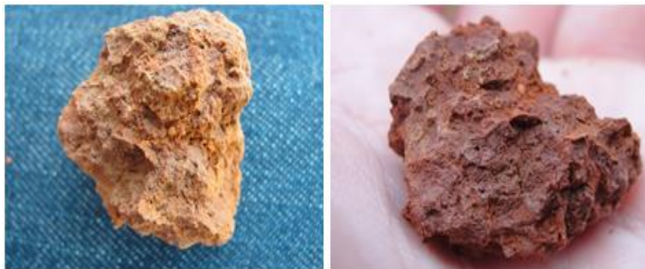
Figura 14. Avaliação de agregado com presença de cerosidade. Fonte: O autor (2015).
