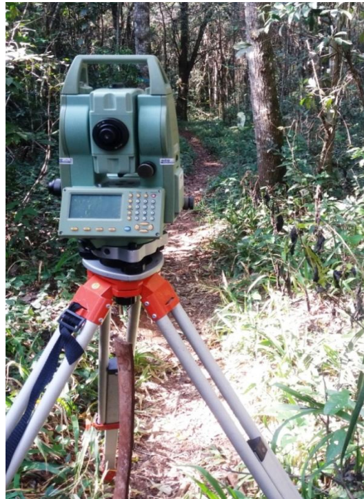
FIGURA 7: estação total FOIF, modelo OTS 685/ RTS – 670.
