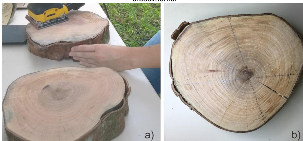
Figura 3 – a) Preparação dos discos de madeira; b) Demarcação para leitura dos anéis de crescimento.
