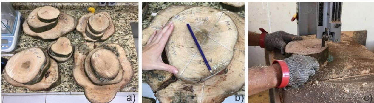
Figura 7 – a) Separação dos discos de madeira de Parapiptadenia rigida ; b) Marcação dos raios para corte das cunhas; c) Corte.
