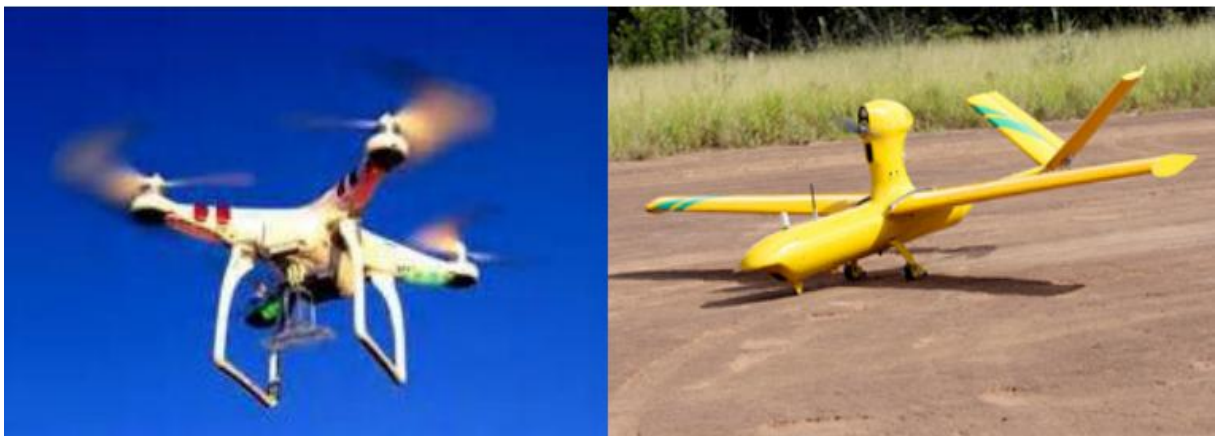
Figura 3: Exemplificação das RPA's, a esquerda uma multirotor, a direita modelo asa fixa.
