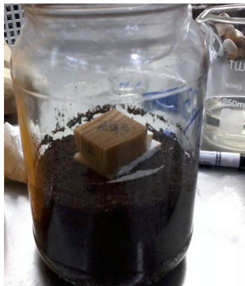
Figura 5 - Amostra de Pinus sp. tratada com o metabólito G. lucidum e colocada sobre a fonte alimentadora infectada pelo fungo T. versicolor . Fonte: A autora (2015).
