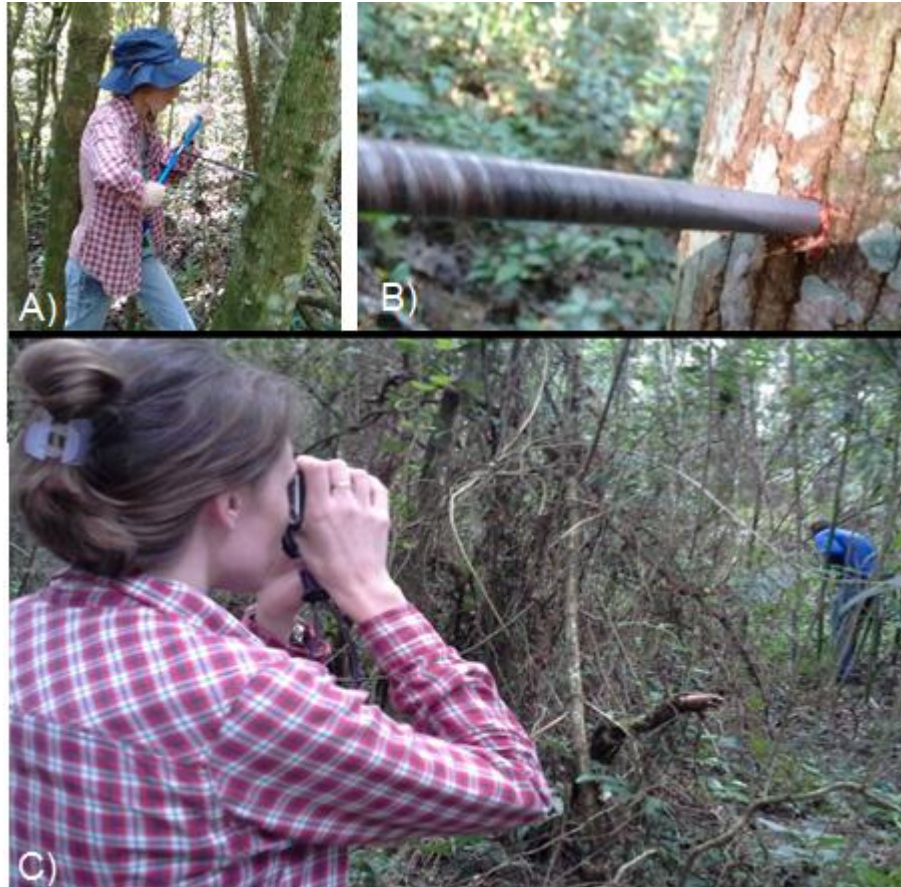
Figura 2. Atividades realizadas a campo. A) e B) procedimento de amostragem utilizando a sonda Pressler. C) Medição da altura de um indivíduo de Hovenia dulcis utilizando hipsômetro VERTEX. Fonte: A Autora.
