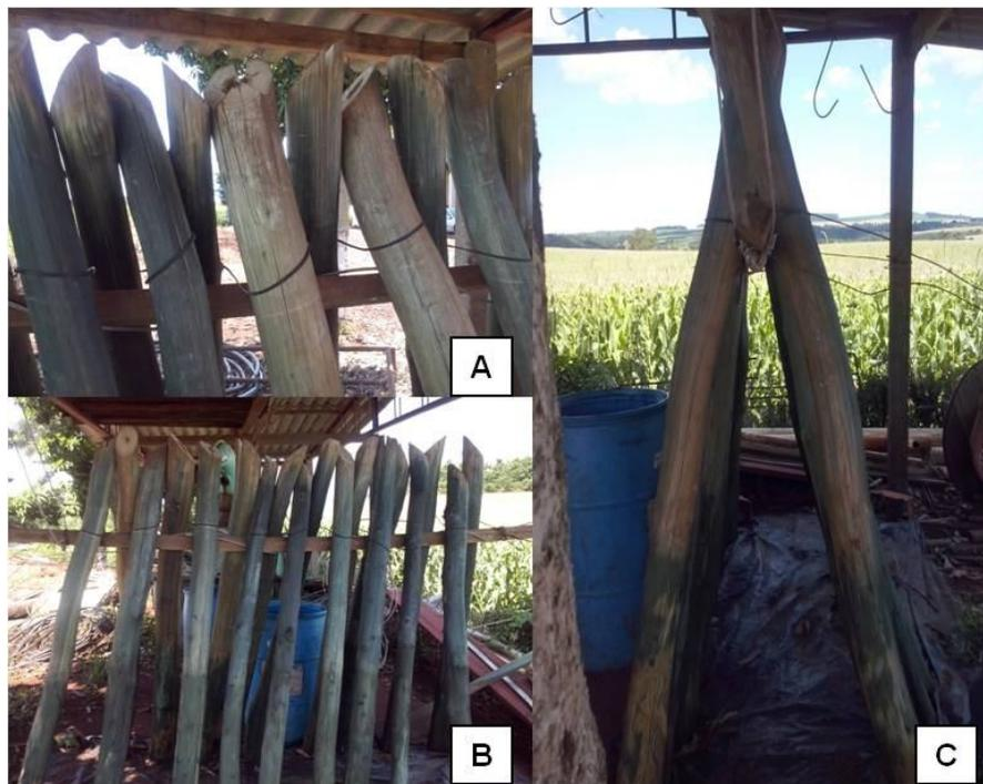
**Figura 6 - Secagem - moirões empilhados em forma de tesoura.**
