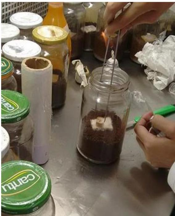
**Fotografia 4: Placa alimentadora com corpo de prova.**
