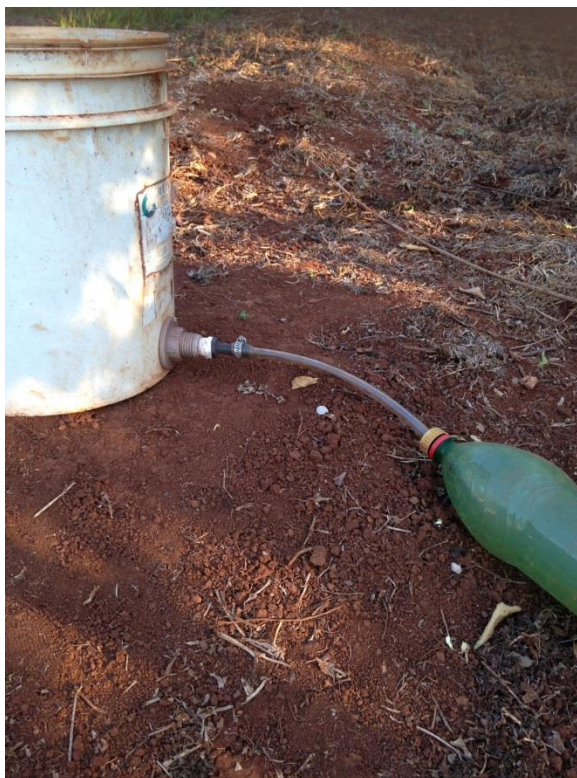
Figura 1: Lisímetro de drenagem utilizado no experimento Fonte: O autor, 2014.
