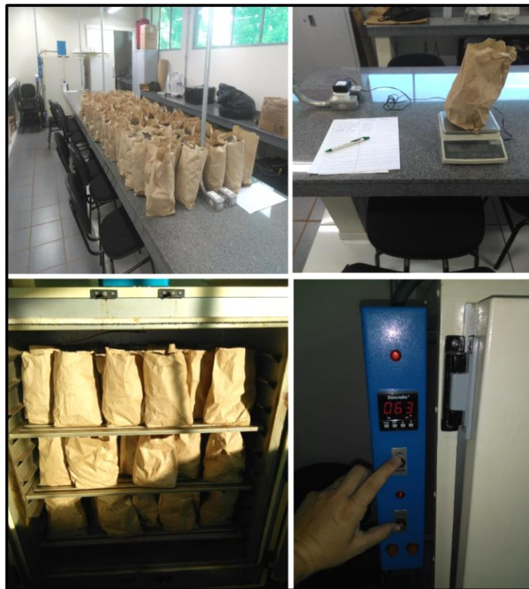
Figura 8- Amostras dispostas em embalagens de papel e processo de pesagem e secagem das amostras de cada fração em laboratório.
