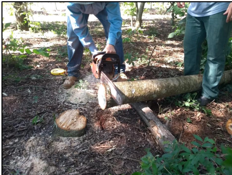
Figura 5- Seccionamento de fuste e retirada de disco a 5% da altura total do fuste.
