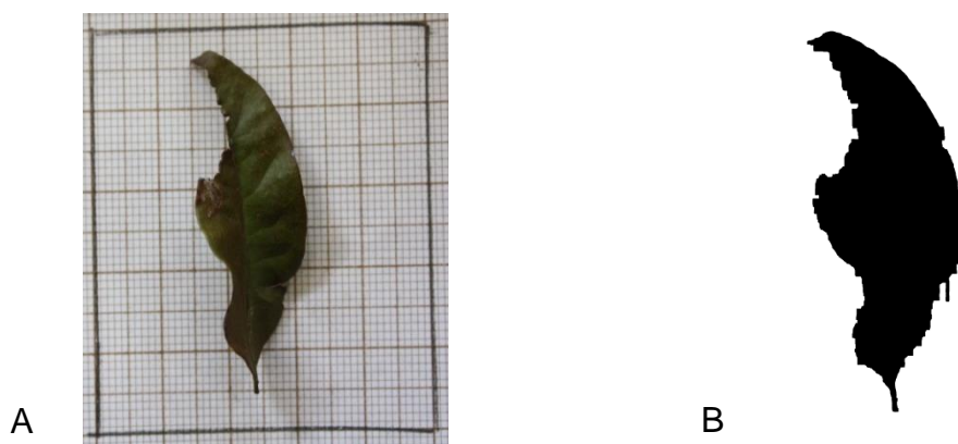
Figura 3 - Etapa do processo obtido pelo programa Image J®. A: Folha real; B: Cálculo da área atacada;
