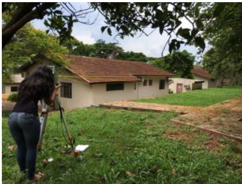
Figura 16: Obtenção dos dados a campo com uso da Estação Total.
