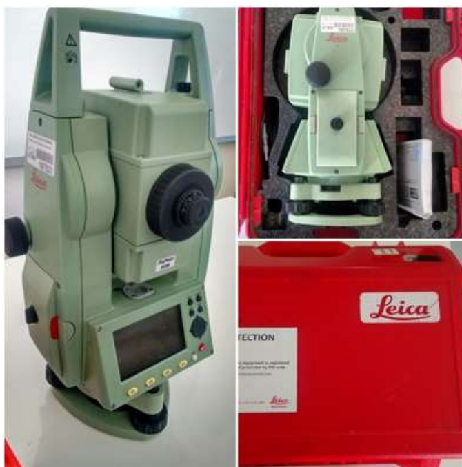
Figura 15: Estação Total Leica utilizada na metodologia a campo.
