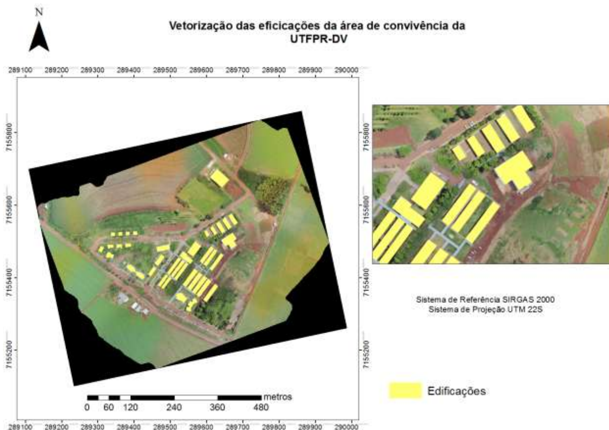
Figura 18: Imagem com a vetorização da área de telhado.
