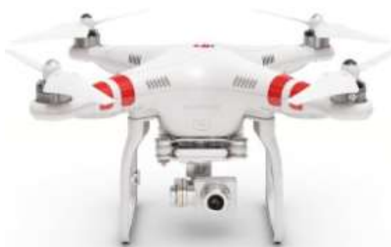
Figura 9: Disposição dos propulsores de um multirotor
