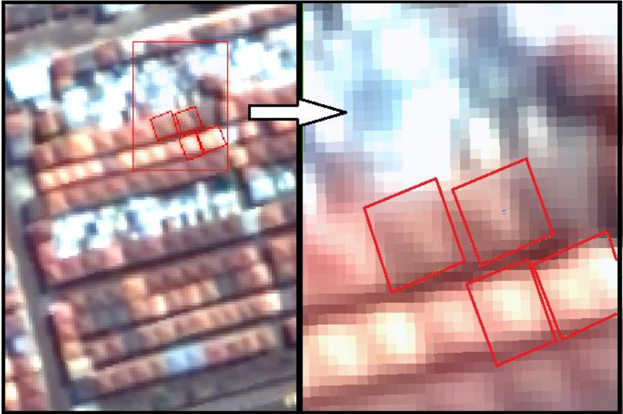
Figura 11: Imagem sensor WorldView-2, tentativa de vetorização, na primeira imagem com escala 1:600 e a segunda com escala 1:100 Fonte: Satélite WorldView-2, UTFPR-DV.
