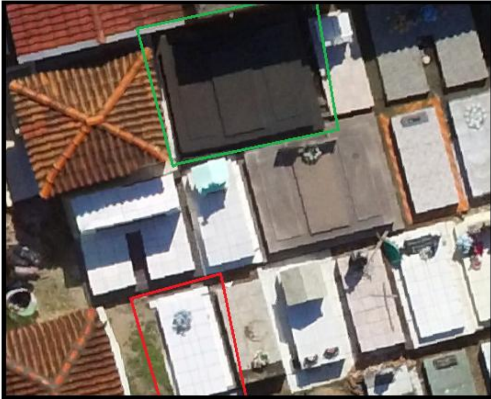
Figura 14 - Visualização dos objetos afetada. Em vermelho pela similaridade de cores entre o túmulo e o entrepiso no chão, dificultando a visualização do vértice; em verde afetado pela sombra da capela ao lado.
