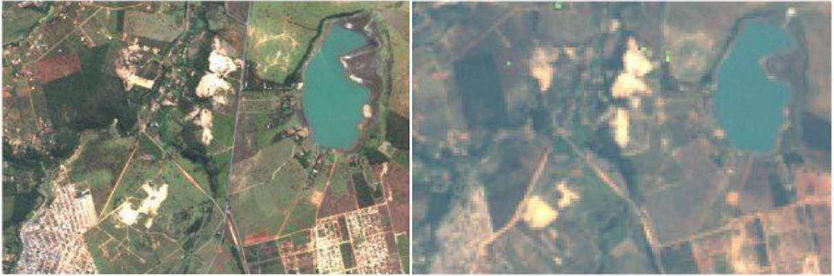
Figura 2 - À esquerda está a imagem do satélite SPOT (5 m de resolução), à direita, imagem do satélite LANDSAT (30 m de resolução) Fonte: VASGEO (2013).
