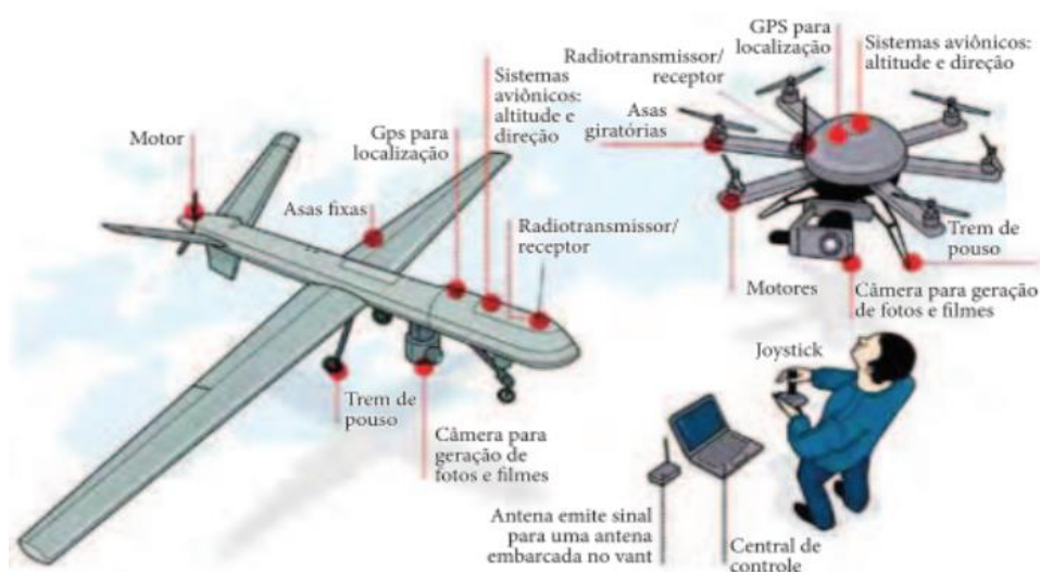
Figura 2 - Diferença entre modelos de VANT de asa-fixa e asas rotativas. Fonte: Bernard et al (2014).
