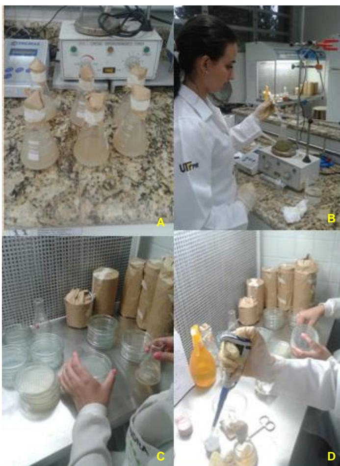
Figura 1. Condução do experimento, A. Meio de cultura BDA; B. Correção do meio com NaOH; C. Meio de cultura sendo vertido em placas de Petri®; D. Produtos sendo adicionados ao meio de cultura.
