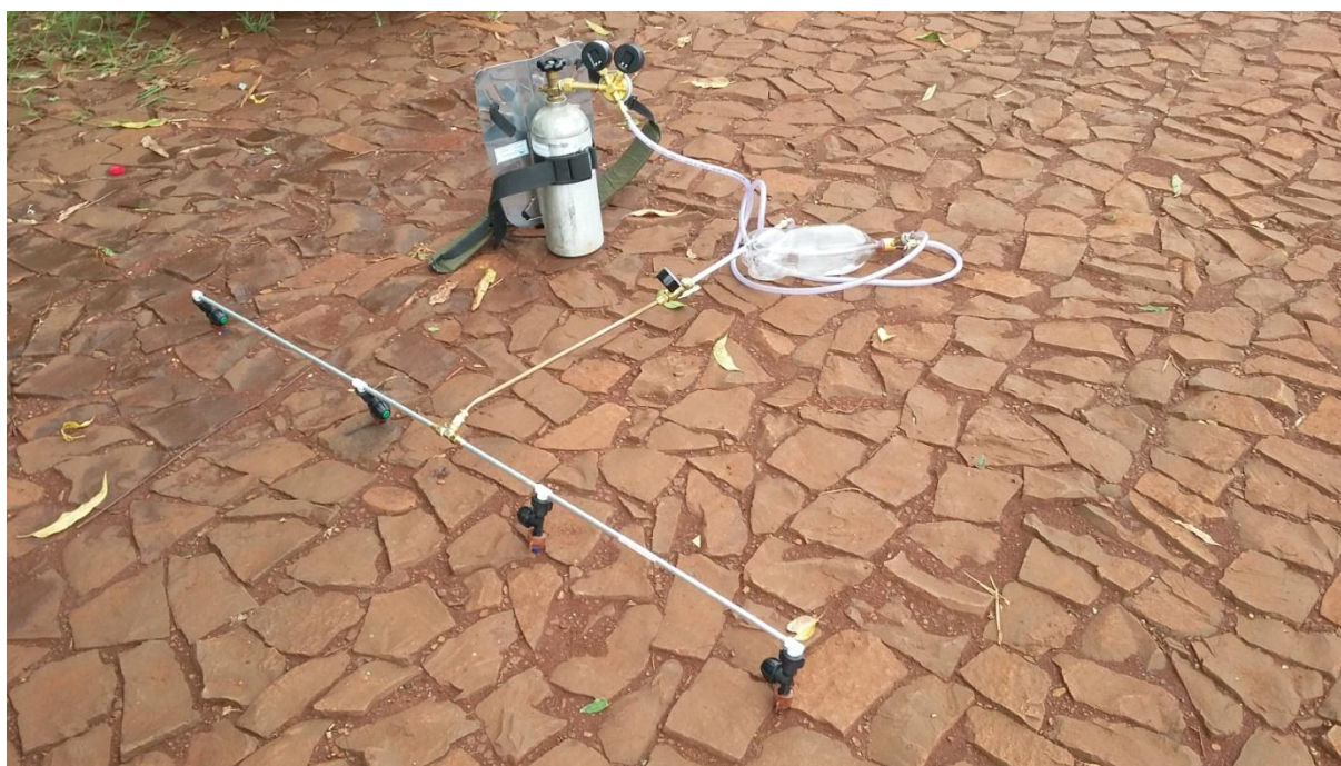
Figura 4: Equipamento pulverizador propelido a CO 2 , equipado de 4 pontas de jato cônico espaçadas a 0,5 metros.
