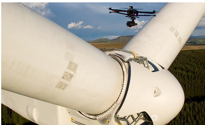
Figura 4 Quadricóptero realizando inspeção em uma turbina eólica Fonte: AerialVision
