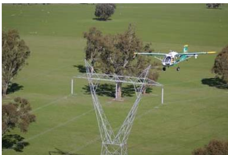
Figura 3 Aeronave tripulada realizando inspeção em uma rede de alta tensão Fonte: Rangel, 2009
