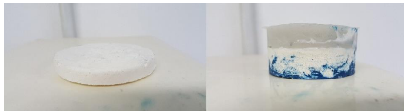
Figura 5 - Corpos de prova de permeabilidade (esquerda) e compressão (direita)
