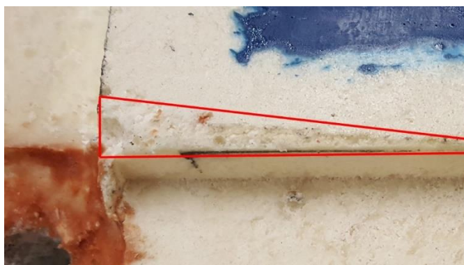
Figura 27 - Defeito na superfície do molde
