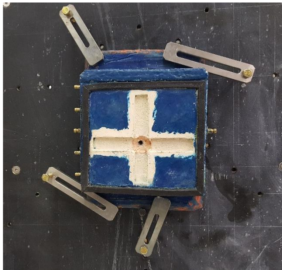
Figura 31 - Molde fixado na máquina protótipo
