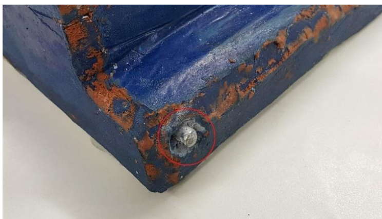
Figura 29 - Vareta horizontal após ser cortada
