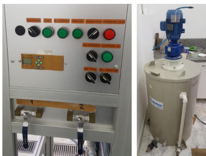
Figura 8 - Painel de comando da máquina e tanque misturador de barbotina
