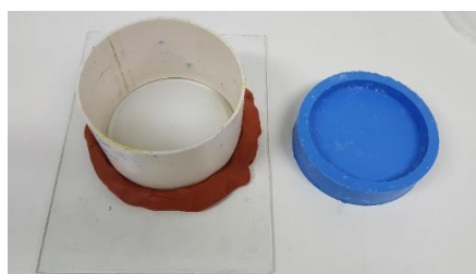
Figura 4 - Conjunto para moldagem e molde de silicone
