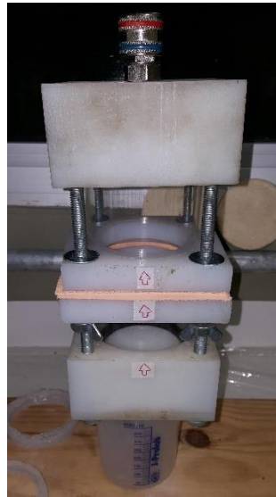
Figura 6 - Aparato para medição de permeabilidade e formação de parede
