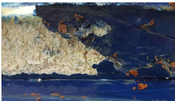
Figura 25 - Camada 1 destruída durante a desmoldagem
