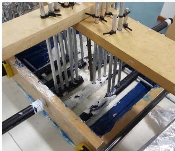
Figura 19 – Montagem do sistema de varetas verticais
