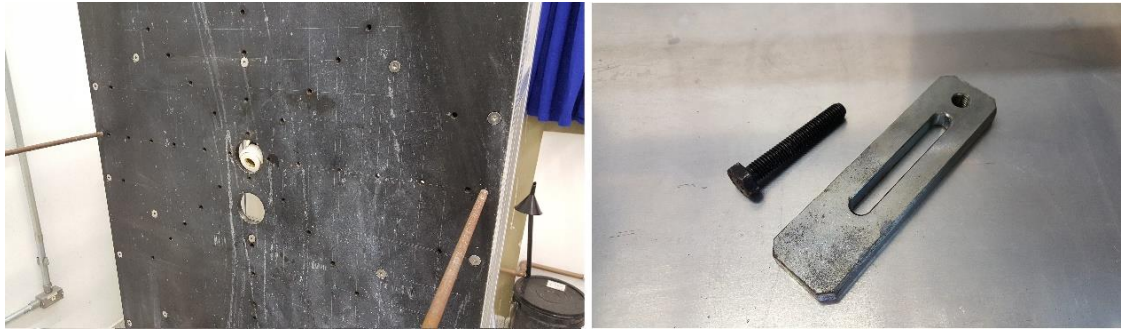
Figura 9 - Placa de fixação e laxa de fixação
