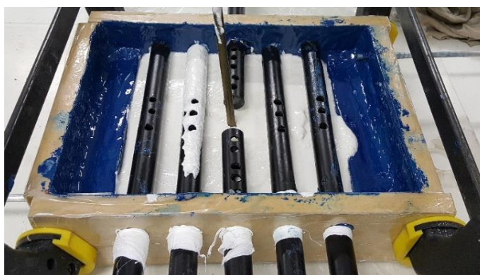
Figura 17 - Camada 2 após aplicação, já com tubos introduzidos
