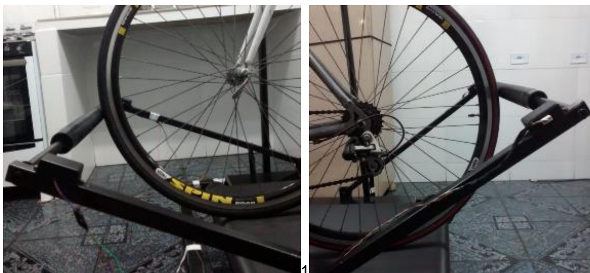
Figura 15 - Sistema de contenção
