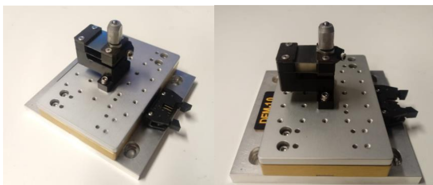
Figura 16 – Célula de Carga do Tribômetro CETR da UTFPR – Ecoville com indentador esférico
