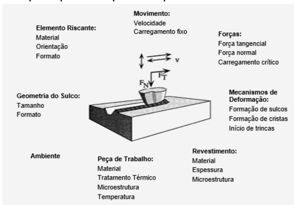
Figura 3 - Esquema apresentando parâmetros que influenciam no ensaio de riscamento
