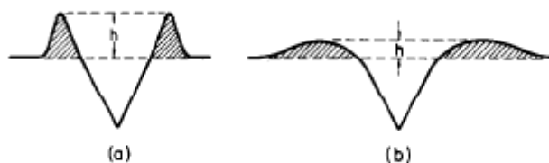
Figura 5 - Esquema apresentando diferentes extremos em um ensaio de riscamento
