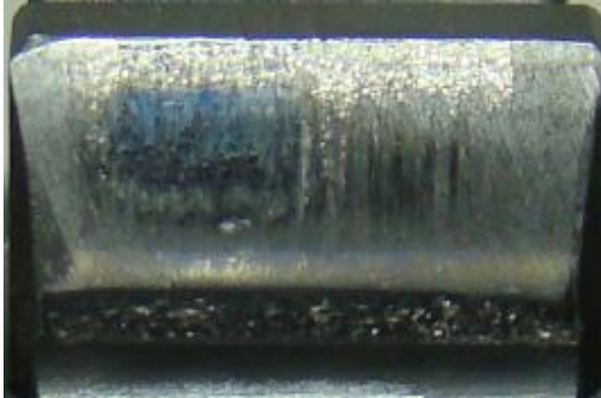
Figura 15 - Dente de engrenagem apresentando Scuffing, Pitting e Abrasão
