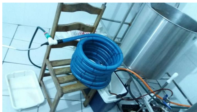
Figura 11 – Sistema de resfriamento atual da nanocervejaria em estudo. 6
