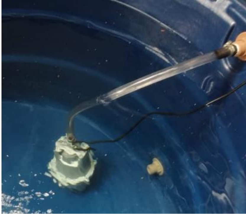
Figura 34 – Montagem da bomba submersa no reservatório termodinâmico.
