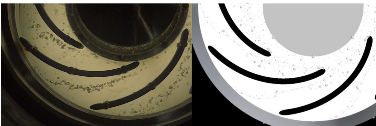
Figura 5.12: Comparação entre o ponto 12 experimental e numérico para vazão de líquido de 2,542Q_{des} e vazão mássica de gás de 0,06kg/h a uma velocidade de rotação de 300 rpm
