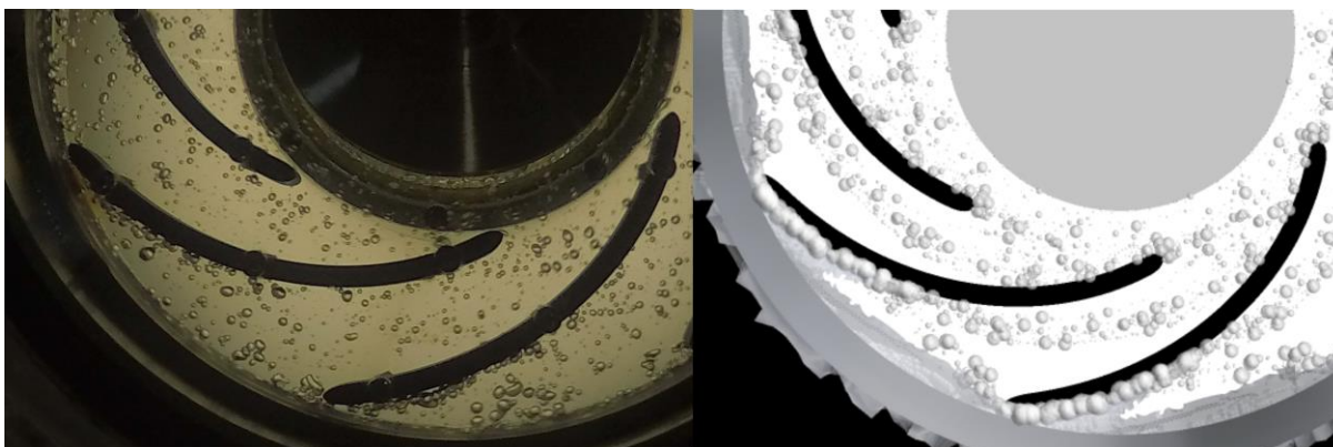
Figura 5.13: Comparação entre o ponto 8 experimental e numérico para vazão de líquido de 1,000Q_{des} e vazão mássica de gás de 0,06\text{kg/h} a uma velocidade de rotação de 300\text{ rpm}
