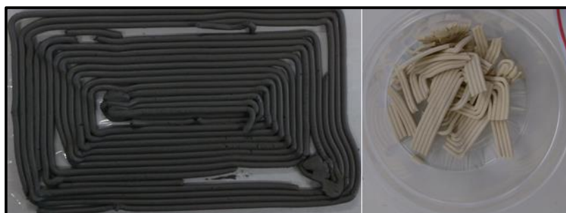
Figura 46 – À esquerda, corpo de prova após impressão, à direita, corpo de prova quebrado queimado
