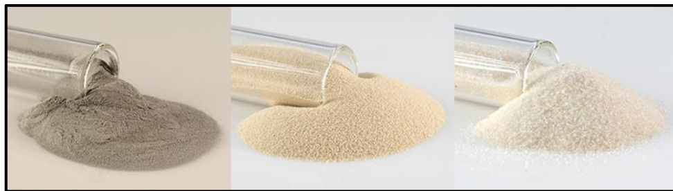
Figura 4 - Ligantes fornecidos pela ExOne. Materiais: Inox 316, Cerâmica e Sílica Fonte: ExOne Materials 14 .
