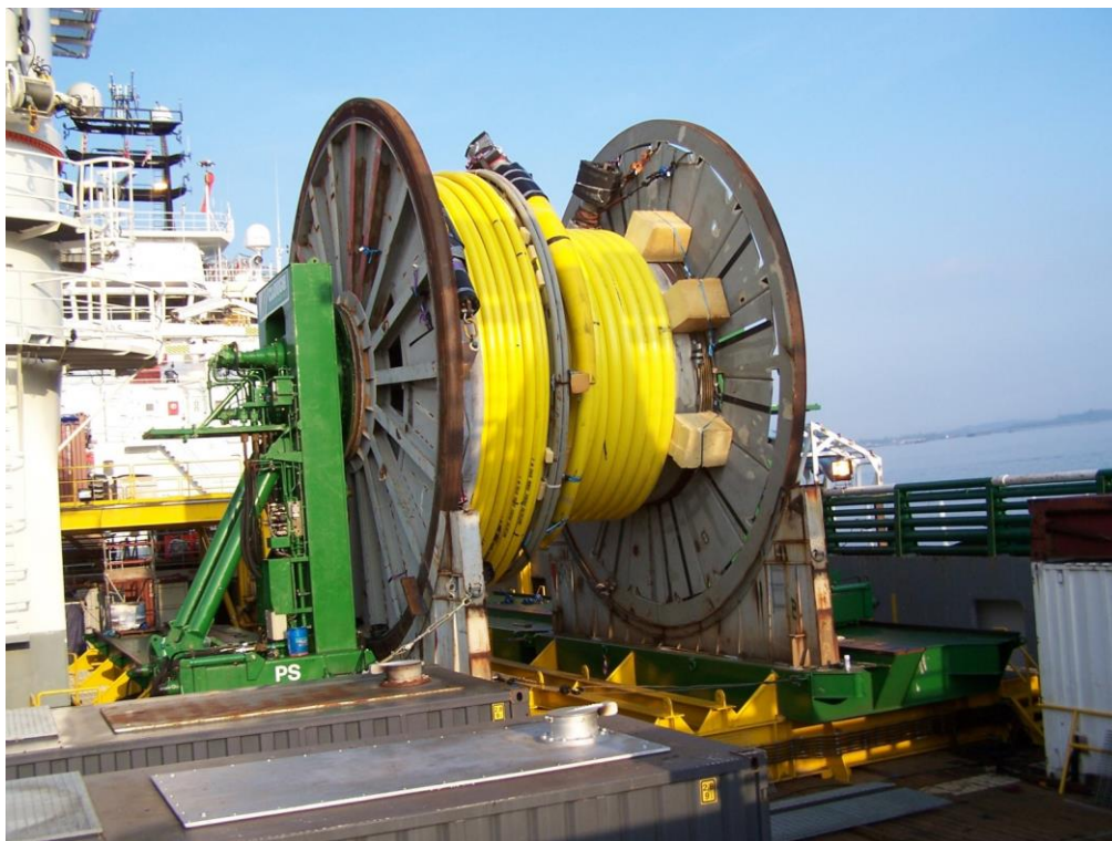
Figura 1.3 Duto flexível enrolado em carretel
