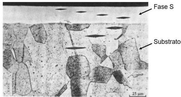
Figura 15 – Típica camada composta por fase S com microidentificações de dureza Knoop. Fonte: Adaptado de Sun, et al. , 2010.
