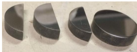
Figura 24 – Amostras preparadas para nitretação.
