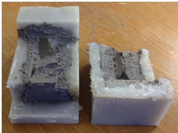
Figura 23 - Molde aberto após injeção da massa cerâmica
