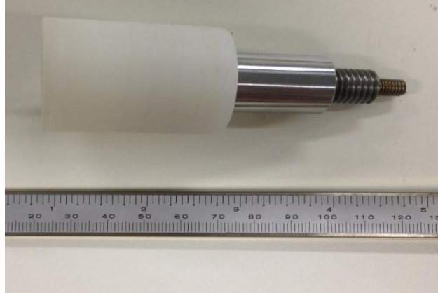
Figura 12 – Êmbolo de aplicação de força ao material dentro do copo para os testes reológicos e de injeção
