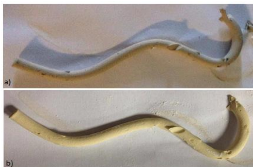
Figura 24 – Exemplo de filamento de massa cerâmica retirado para medida de retração: a) após a saída do bico e b) após a queima
