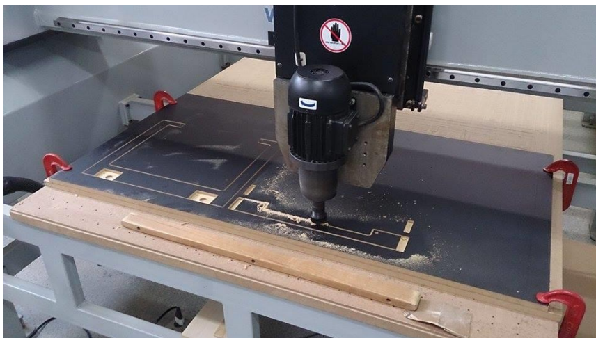
Figura 47 – Máquina CNC com a chapa em processo de fabricação Fonte: Do autor (2015).
