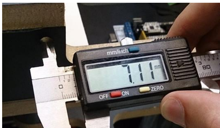
Figura 61 – Variação dimensional do furo para o eixo Y Fonte: Do autor (2015).
