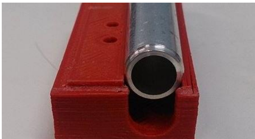
Figura 58 – Interferência na montagem das buchas na ponta de eixo
