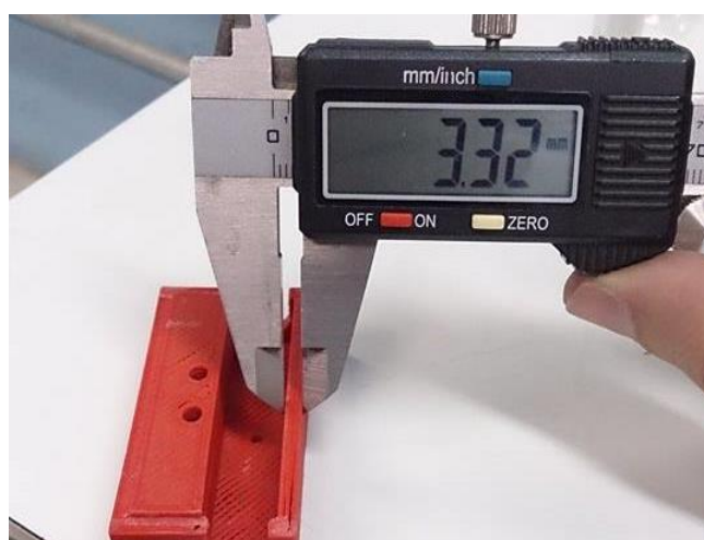
Figura 55 – Leitura da espessura da parede com distorções dimensionais Fonte: Do autor (2015).
