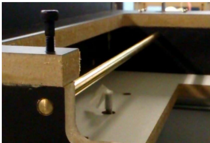
Figura 62 – Eixo Y montado após retrabalho nos furos Fonte: Do autor (2015).
