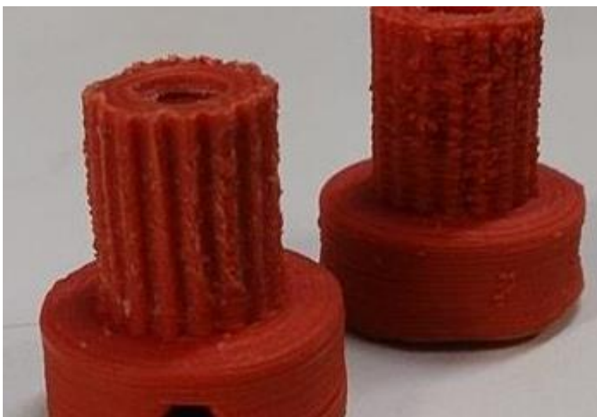
Figura 53 – Polia com os dentes retrabalhados (esquerda) ao lado da polia recém-fabricada (direita)
