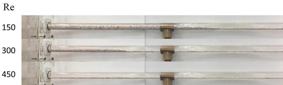
Figura 5.22 - Instantes finais para cada Reynolds utilizados no processo de preenchimento da fratura para  $C_P = 2,5\%$  e  $Q_V = 0,75$ .
