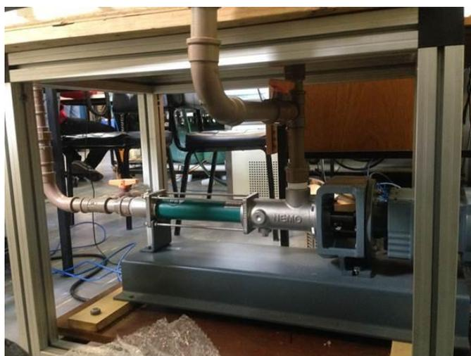
Figura 4.5 - Bomba helicoidal utilizada no experimento.
