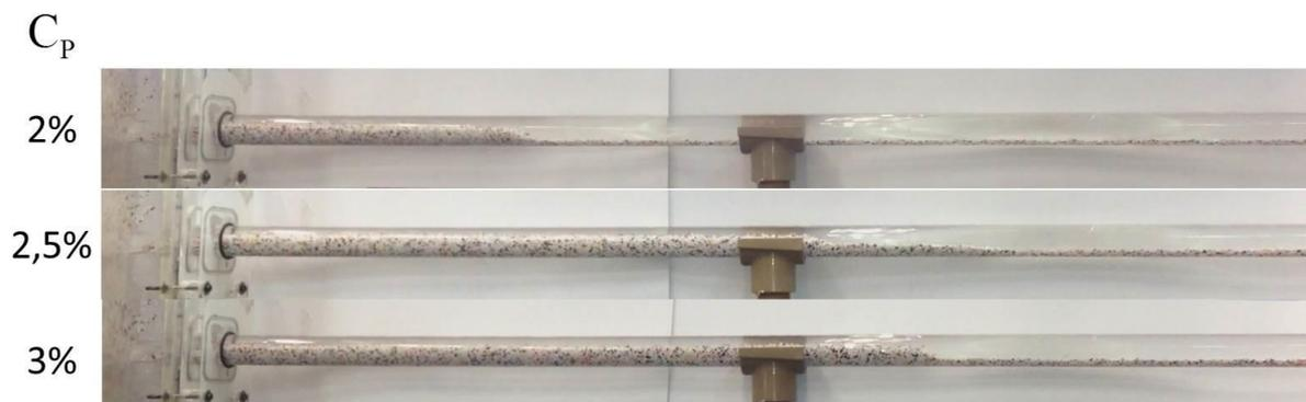
**Figura 5.16 - Instantes finais para cada concentração de partículas utilizadas no processo de preenchimento da fratura para  $Re = 150$  e  $Q_V = 0,75$ .**
