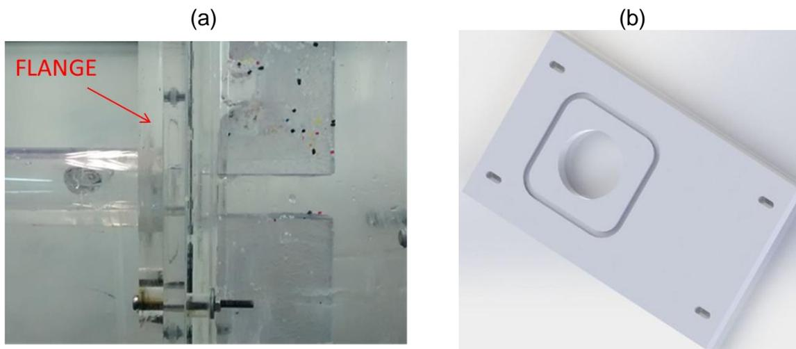
Figura 4.9 - Flange de conexão da fratura com o canal da seção de testes: (a) posição de montagem e (b) projeto tridimensional
