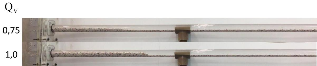
**Figura 5.26 - Instantes finais para cada vazão de fuga utilizada no processo de preenchimento da fratura para  $Re = 300$  e  $C_P = 4\%$ .**
