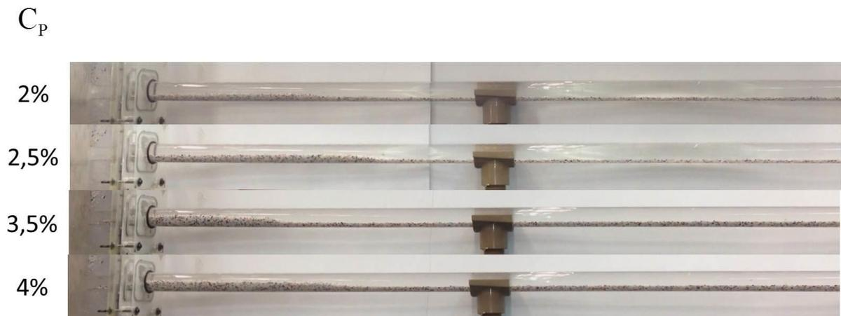
**Figura 5.20 - Instantes finais para cada concentração de partículas utilizadas no processo de preenchimento da fratura para  $Re = 300$  e  $Q_V = 0,75$ .**
