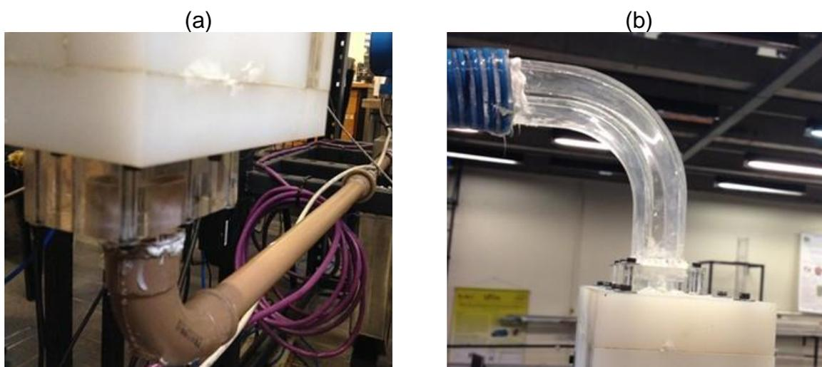
**Figura 4.12 - Detalhe dos bocais da seção de testes: (a) entrada e (b) saída.**
