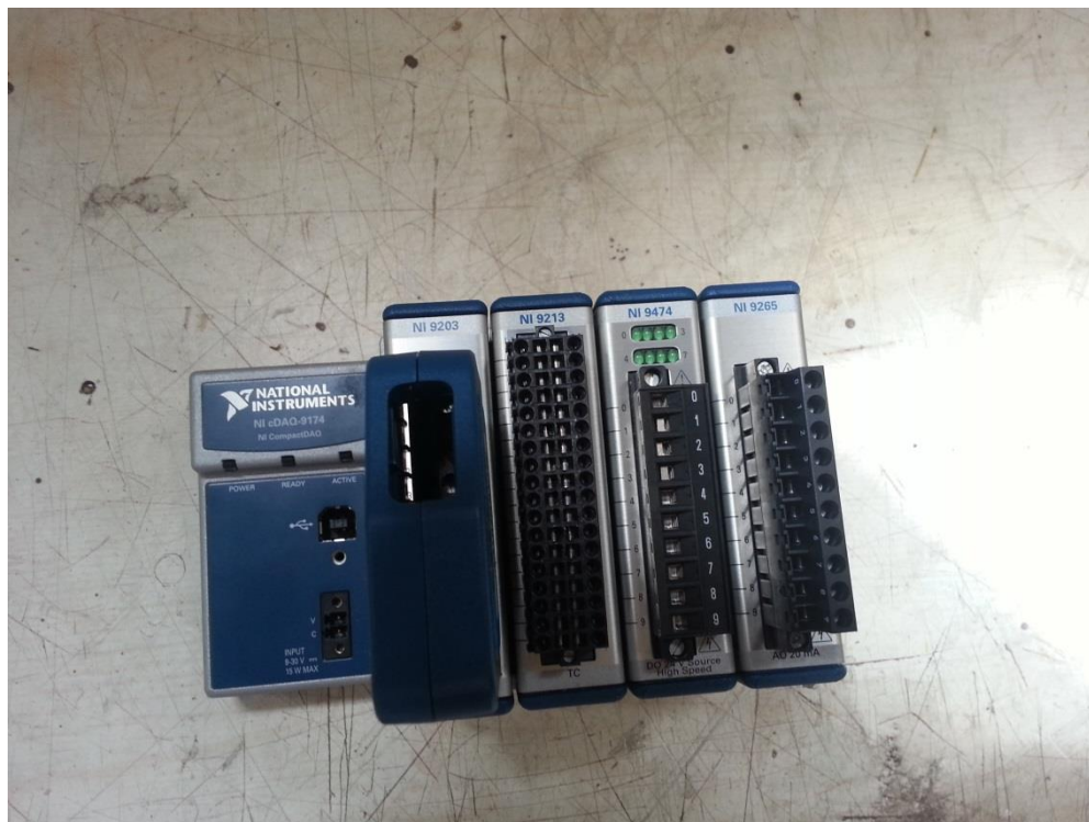
Figura 29. Chassi e as quatro placas NI CompactDAQ de aquisição de dados
