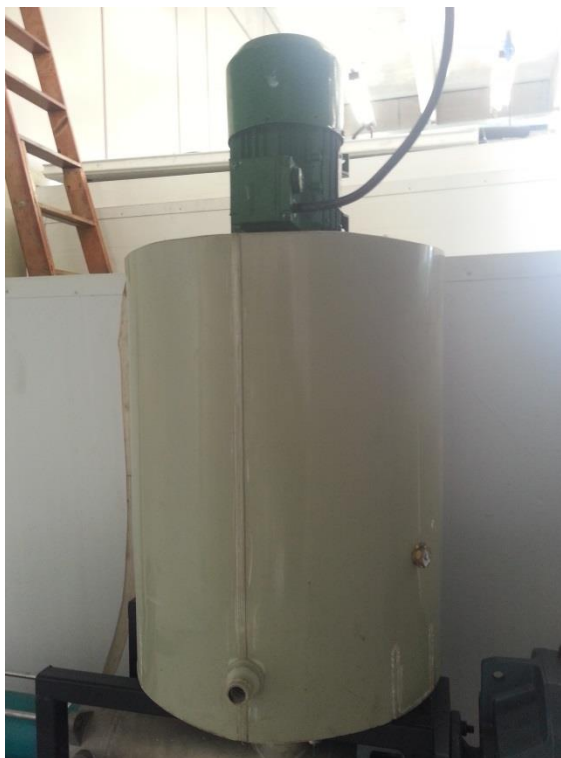
Figura 11. Reservatório de fluido de perfuração e motor agitador
